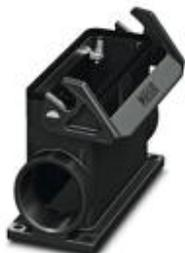
Sockelgehäuse B24, mit Längsbügel, Material: Polyamid, Kabelabgänge: 2, seitlich, Höhe: 84 mm, Kabelverschraubung: ohne, Stutzen: nein, 2x M40, Standard
