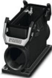
Sockelgehäuse B24, mit Querbügel, Material: Polyamid, Kabelabgänge: 2, seitlich, Höhe: 84 mm, Kabelverschraubung: ohne, Stutzen: nein, 2x M40, Standard
