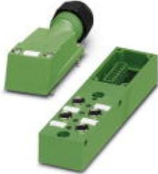
Sensor-/Aktor-Box, Anwendung: Standard, Anschlussart: M8-Buchse Metall, Anzahl der Steckplätze: 4, Polzahl: 3, Kodierung: A - Standard, Steckplatzbelegung: einfach, Statusanzeige: Ja, pnp; Stammleitungsanschluss: Steckbarer Schraubanschluss 180°, Schirmung: nein
