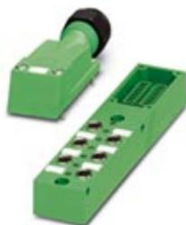
Sensor-/Aktor-Box, Anwendung: Standard, Anschlussart: M8-Buchse Metall, Anzahl der Steckplätze: 6, Polzahl: 3, Kodierung: A - Standard, Steckplatzbelegung: einfach, Statusanzeige: Ja, pnp; Stammleitungsanschluss: Steckbarer Schraubanschluss 180°, Schirmung: nein
