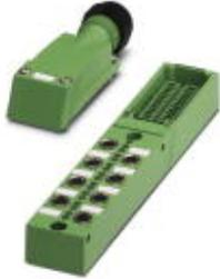
Sensor-/Aktor-Box, Anwendung: Standard, Anschlussart: M8-Buchse Metall, Anzahl der Steckplätze: 8, Polzahl: 3, Kodierung: A - Standard, Steckplatzbelegung: einfach, Statusanzeige: Ja, pnp; Stammleitungsanschluss: Steckbarer Schraubanschluss 180°, Schirmung: nein
