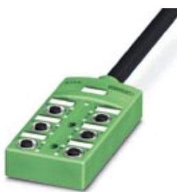
Sensor-/Aktor-Box, Anwendung: Standard, Anschlussart: M12-SPEEDCON-Buchse Metall, Anzahl der Steckplätze: 6, Polzahl: 4, Kodierung: A - Standard, Steckplatzbelegung: einfach, Statusanzeige: Ja, pnp; Stammleitungsanschluss: Festanschluss 180°, PUR/PVC, Leitungslänge: 10 m, Schirmung: nein
