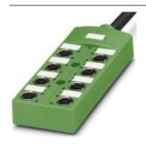
Sensor-/Aktor-Box, Anwendung: Standard, Anschlussart: M12-SPEEDCON-Buchse Metall, Anzahl der Steckplätze: 8, Polzahl: 5, Kodierung: A - Standard, Steckplatzbelegung: doppelt, Statusanzeige: Ja, pnp; Stammleitungsanschluss: Festanschluss 180°, PUR/PVC, Leitungslänge: 10 m, Schirmung:
