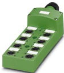
Sensor-/Aktor-Box, Anwendung: Standard, Anschlussart: M12-SPEEDCON-Buchse Metall, Anzahl der Steckplätze: 8, Polzahl: 5, Kodierung: A - Standard, Steckplatzbelegung: doppelt, Statusanzeige: Ja, pnp; Stammleitungsanschluss: Steckbarer Schraubanschluss 180°, Schirmung: nein
