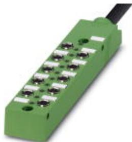
Sensor-/Aktor-Box, Anwendung: Standard, Anschlussart: M8-Buchse Metall, Anzahl der Steckplätze: 10, Polzahl: 3, Kodierung: A - Standard, Steckplatzbelegung: einfach, Statusanzeige: Ja, pnp; Stammleitungsanschluss: Festanschluss 180°, PUR/PVC, Leitungslänge: 5 m, Schirmung: nein
