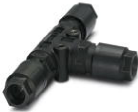
QUICKON T-Verteiler, schwarz, 4+PE-polig, 1,0 mm 2 ... 2,5 mm 2 / 690 V / 20 A, für Kabeldurchmesser 9 mm ... 16 mm, mit drei Quickon-Muttern
