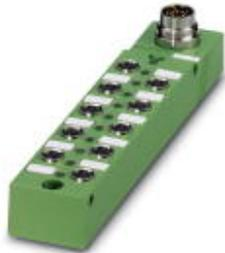
Sensor-/Aktor-Box, Anwendung: Standard, Anschlussart: M8-Buchse Metall, Anzahl der Steckplätze: 10, Polzahl: 3, Steckplatzbelegung: einfach, Statusanzeige: Ja, pnp; Stammleitungsanschluss: M16-Steckanschluss 90°, Schirmung: nein
