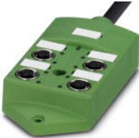
Sensor-/Aktor-Box, Anwendung: Standard, Anschlussart: M12-SPEEDCON-Buchse Metall, Anzahl der Steckplätze: 4, Polzahl: 4, Kodierung: A - Standard, Steckplatzbelegung: einfach, Statusanzeige: Ja, pnp; Stammeitungsanschluss: Festanschluss 180°, PUR/PVC, Leitungslänge: 10 m, Schirmung: nein
