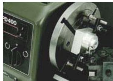
**Spannzangeneinrichtung mit Spannzangen für PD 400**
