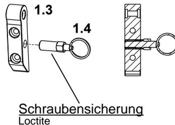
Montieren Sie den Rastbolzen so, dass er bei gezogenem Stift bündig sitzt. Sichern Sie ihn mit Schraubensicherungsmittel.
