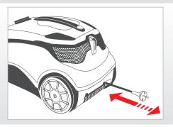
Ziehen Sie den Netzstecker aus der Steckdose. Ziehen Sie das Netzanschlusskabel mit leichtem Zug vom Gerät weg und lassen Sie es los. Das Kabel rollt sich dann automatisch auf.
