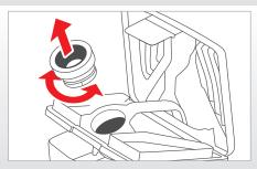
Bei starker Verschmutzung kann der sogenannte Ejektor durch Drehen der Stutzendichtung für die Reinigung entnommen werden. Spülen Sie den Ejektor mit warmem Wasser ab.
