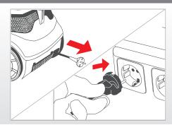
Greifen Sie das Netzanschlusskabel am Netzstecker.
