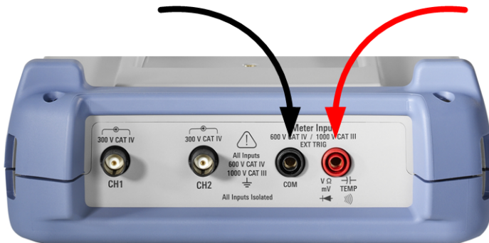
Bild 4-1: Multimeter-Eingänge für den Anschluss von Testkabeln
