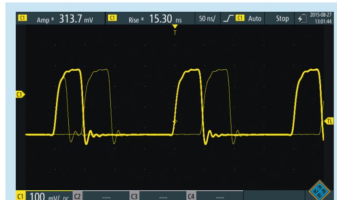
Das High-Speed-Erfassungssystem des R&S®ScopeRider erfasst bis zu 50 000 Messkurven pro Sekunde und deckt seltene und unerwartete Signalanomalien auf.
