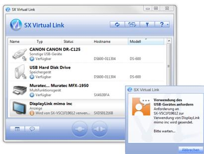
Mithilfe von SX Virtual Link kann die Verbindung zu einem entfernten USB-Gerät hergestellt oder getrennt werden. Beim Status "In Verwendung" können andere Anwender die Benutzung des USB-Gerätes anfordern.
