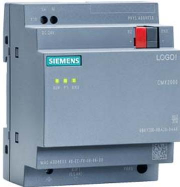
LOGO! CMK2000 Kommunikationsmodul zum INTEGRIEREN der LOGO! 8 "in den Gebäudesystembus KNX;" Anschluss DC 24V 0,04A 1 RJ45 Port für Ethernet 50 Kommunikationsobjekte Uhrzeit-Synchronisation Konfiguration/Diagnose per Web-Interface
