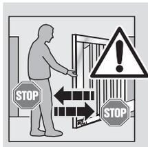
Weisen Sie alle Personen, die die Toranlage benutzen, in die ordnungsgemäße und sichere Bedienung ein. Demonstrieren und testen Sie die mechanische Entriegelung sowie den Sicherheitsrücklauf. Halten Sie dazu das Tor während des Torzulaufes mit beiden Händen an. Die Toranlage muss den Sicherheitsrücklauf einleiten.
