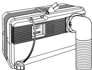
4. Führen Sie die Spitze der Flasche in den Anschlussstutzen des Geräts und drücken Sie den kompletten Inhalt langsam in die Öffnung.
