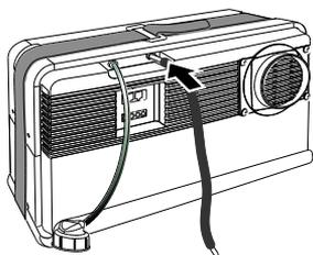
1. Stecken Sie den isolierten Abgasschlauch auf.
