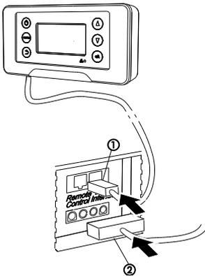
1. Ziehen Sie das Ladekabel (2) und das Datenkabel (1) für das Bedienpanel von der EFOY COMFORT Brennstoffzelle ab.
