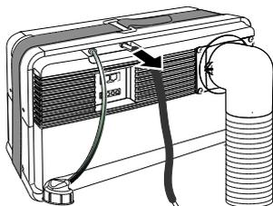
3. Ziehen Sie den Abgasschlauch vom Gerät ab. Achten Sie darauf, dass kein Schmutz und keine Fremdkörper in die Einfüllöffnung eindringen.
