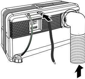
4. Setzen Sie dann das Abwärmerohr ein.
