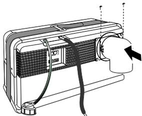
2. Setzen Sie das Abwärmerohr oder den Abwärmebogen ein.
