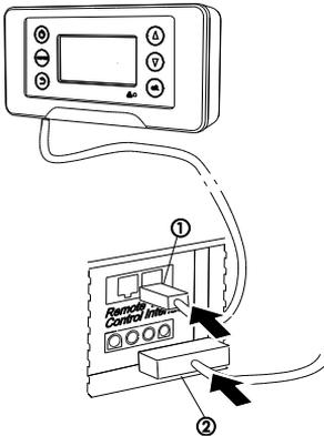
1. Stecken Sie den Stecker der Datenleitung (1) in den Anschluss "Remote Control" der EFOY COMFORT Brennstoffzelle.
