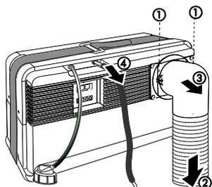
1. Lösen Sie die Schrauben (1) am Abwärmebogen.
