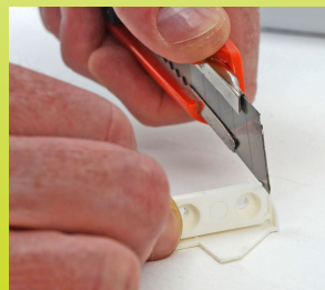
Abb. 7: Montagehilfe 'Segel' (D1) der Fensterrahmen-Halterung (D) abschneiden
