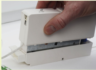
Abb. 29: Oberen Gehäuseteil mit dem unteren verbinden
