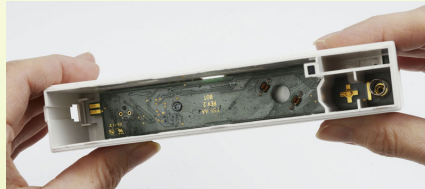
Abb. 41: Plus- und Minuspol der Batterien
