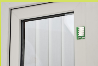
Abb. 32: Fertig fixierter Regensensor
