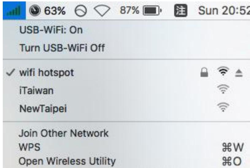
4. Sie können die anderen Elemente im Menü benutzen, um Ihren USB-Adapter ein-/auszuschalten, eine Verbindung zu einem weiteren Netzwerk herzustellen (SSID-Name manuell eingeben), die WPS-PIN anzuzeigen oder um den WPS-Drucktastenmodus zu aktivieren.
