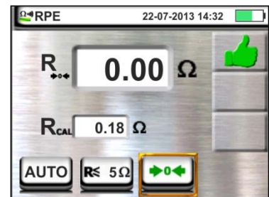
Abb. 7: Kompensation des Widerstandes von Einzelkabeln und Tastkopf
