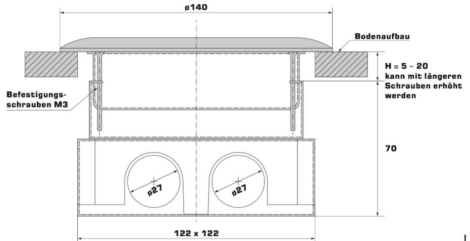
**Datenblatt:** Boden- und Wand-Einbausteckdosen mit versenkbarer Flügelöffnung
