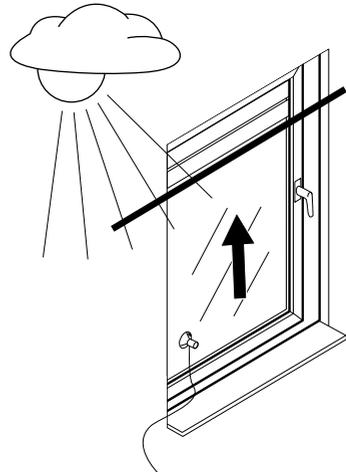
Wird die eingestellte Helligkeit ca. 10 Minuten ununterbrochen erkannt, fährt der Rollladen bis zur Position des Sensors nach unten. Nach ca. 20 Minuten wird der Rollladen ein Stück hochgezogen und der Saugknopf ist freigegeben und misst erneut.
