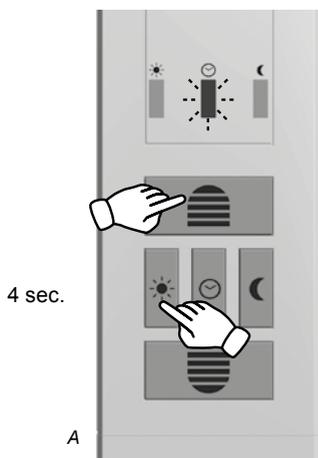
Durch das Drücken der beiden Tasten wird der Rolldrive 65 PREMIUM in den Programmiermodus versetzt. Ab diesem Zeitpunkt muss innerhalb 10 Sekunden der Funk-Handsender gekoppelt werden (Schritte 60 bis 65). Sind 10 Sekunden vergangen ohne den Funk-Handsender zu koppeln, muss der Rolldrive 65 PREMIUM durch das Wiederholen des Schrittes 60 erneut in den Programmiermodus versetzt werden.
