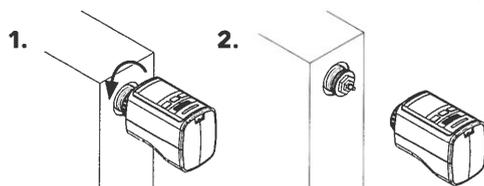
Um Heizkörperthermostat HT100 BT zu demontieren stellen Sie auf Pos. EIN, drehen Sie hierzu am Drehrad über die höchste Temperatur von 28 C° hinaus bis EIN im Display erscheint. Warten Sie kurz bevor Sie die Schraubverbindung lösen. Ziehen Sie Heizkörperthermostat HT100 BT dann vom Ventil ab.
