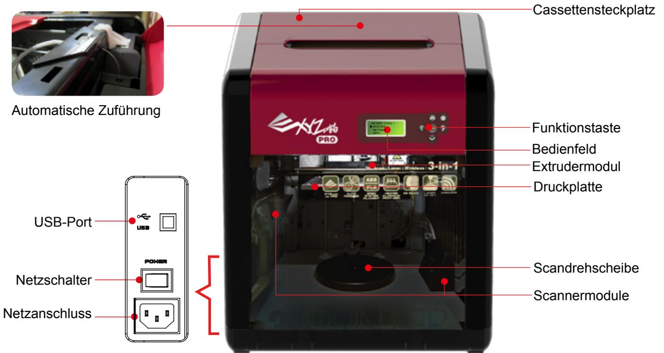
**!** Die Ebenheit der Druckplatte kann durch Vibrationen während des Transports beeinträchtigt werden, was sich auf die Druckqualität auswirken kann. Bitte passen Sie vor dem Druck die Druckplatte an; beachten Sie dazu « Druckplatte anpassen ».
