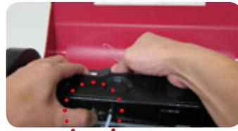
\*Sie sollten die Spitze des Filaments in einem 45-Grad-Winkel abschneiden und das Filament begradigen, damit es sich leichter einführen lässt.
