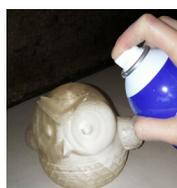
Gummischicht auf das transluzente Objekt auftragen
