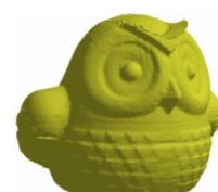
Scanergebnis des mit Gummispray behandelten Objekts
