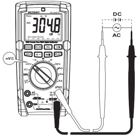
→ Der Spannungsbereich „mV“ weist einen Eingangswiderstand von  $\geq 10 \text{ M}\Omega$  auf. Bei offenen Messeingängen kann aufgrund der hohen Empfindlichkeit ein undefinierter Messwert angezeigt werden, der jedoch keinen Einfluss auf das Messergebnis hat.
