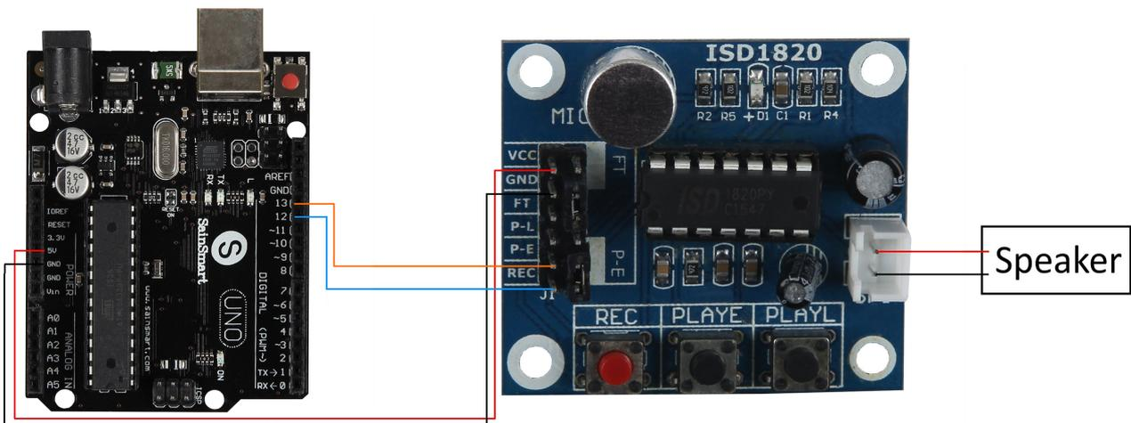
Bild 1: Verbindung zwischen Modul und Arduino
