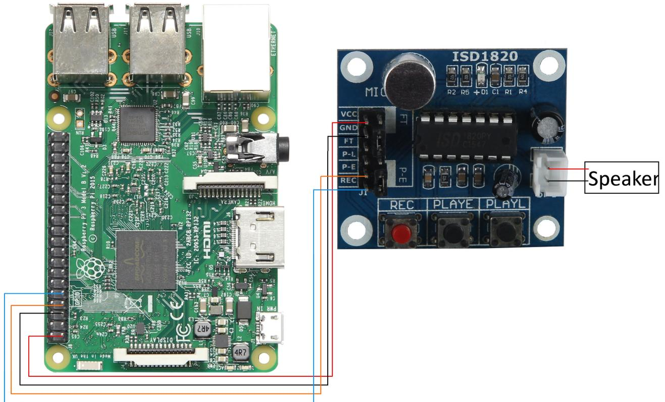
Bild 2: Verbindung zwischen Modul und Raspberry Pi
