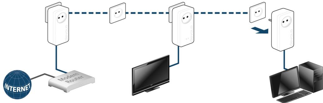
Abb. 6 Entfernen eines dLAN-Adapters
