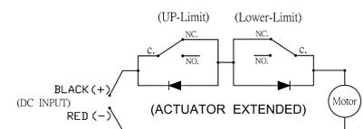
rotes Kabel an „+“ und schwarzes Kabel an „-“: Zylinder fährt aus
