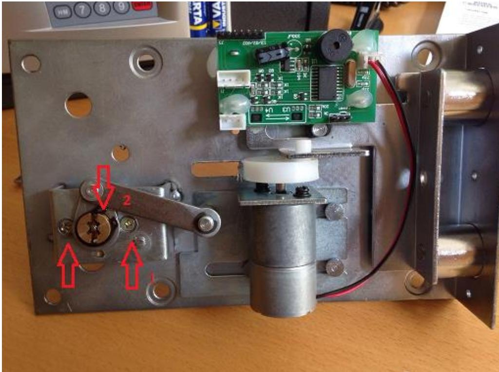
Drehen Sie die beiden Schrauben (1) heraus, jetzt können Sie das Notschloss entfernen.
