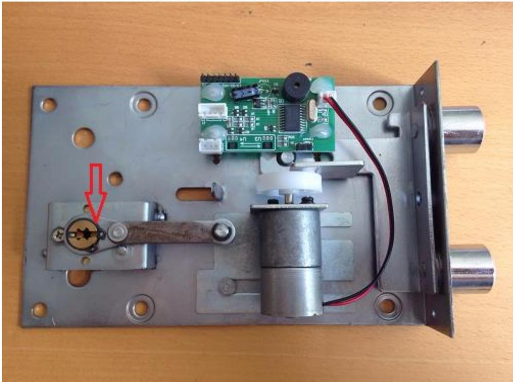
Lösen Sie die Platine von den vier Haltern. Evtl. muss hierzu der Heisskleber entfernt werden. Und lösen Sie alle Steckverbinder auf der Platine.
