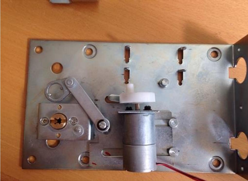
Ziehen Sie das Treibrad vom Motor ab und entfernen Sie die beiden Schrauben.
