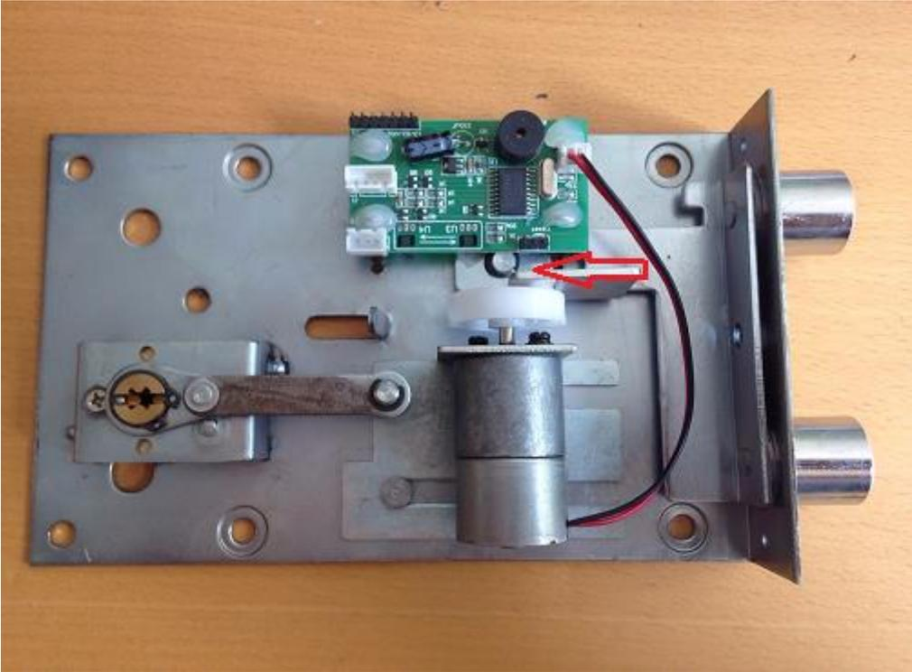
Entfernen Sie zuerst das Riegelwerk, danach den Motorhalter.
