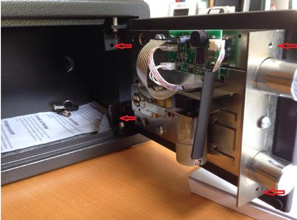
2.)Lösen Sie alle Steckverbindungen auf der Platine. Schrauben Sie die 4 Kreuzschlitzschrauben der Schlossplatte ab.
