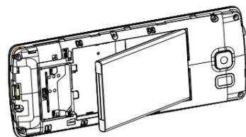
und stellen Sie beim Hineinschieben in das Akkufach sicher, dass die drei Kontakte an der Vorderseite die drei Federkontakte im Akkufach berühren.
