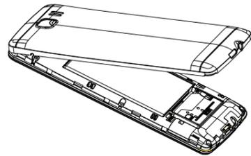
Schieben Sie einen Fingernagel in die Vertiefung der linken Kerbe.
