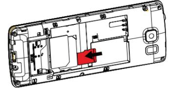
Schieben Sie die Karte vorsichtig in die Kartenhalterung neben der SIM-Kartenhalterung. Achten Sie darauf, dass die Kontakte der Speicherkarte nach unten zeigen und dass die Karte entsprechend dem markierten Bereich platziert wird (siehe Abbildung). Die Kontakte der Karte dürfen nicht zerkratzt oder verbogen werden.
