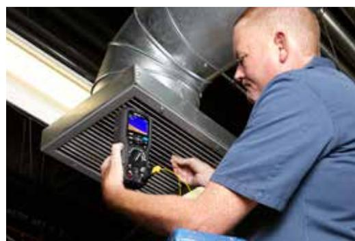
Typ-K-Thermoelement-Eingang zum Ausführen von Temperaturdifferenzmessungen
