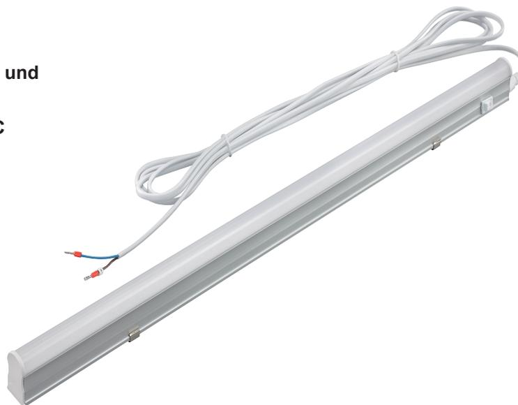
LED Stableuchte mit 44 energiesparenden LEDs. Die Leuchte kann bequem über 2 Montageclips montiert werden. Der elektrische Anschluss erfolgt über ein 5 m langes Anschlusskabel mit offenen Enden. Das Ein- und Ausschalten der Leuchte erfolgt über einen eingebauten Kippschalter.
