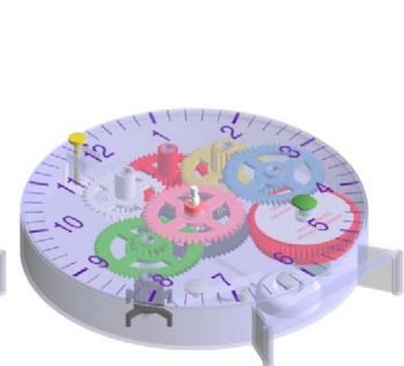
16. Stecken Sie den **Pendelbolzen** durch die Öffnung im **Ziffernblatt**
