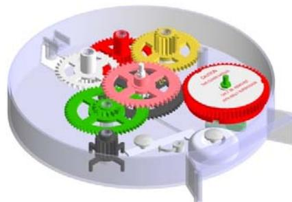
13. Legen Sie das **Federhausrad** mit der beschrifteten Seite nach oben auf die **Sperrklinke** und stecken Sie das **Federhausrad** auf den **Schlüssel**
