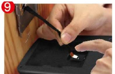
Schließen Sie das Kabel an der Buchse des Senders an.
