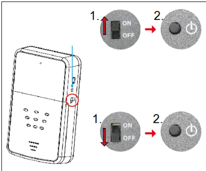
**1. und 2. mit PFEIL NACH OBEN:** Überwachungsmodus: Stellen Sie den Schalter auf „ON“ (EIN), um den Überwachungsmodus zu wählen und drücken Sie die Starttaste zur Bestätigung. In diesem Modus können Sie sehen, was vor der Tür vor sich geht, wenn Sie „OK“ auf dem Monitor drücken.
