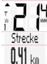
Im **oberen Bereich** des Displays wird permanent die aktuelle Geschwindigkeit angezeigt.
