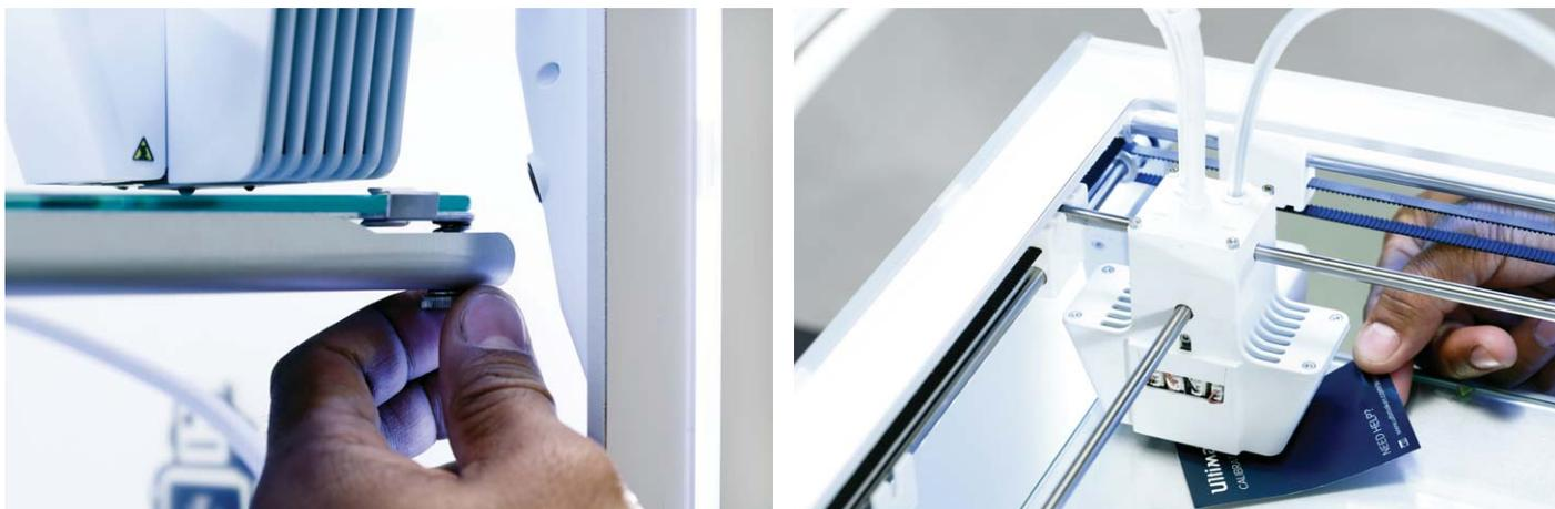
Nach der Kalibrierung des Druckbetts mit der ersten Düse muss die zweite Düse ebenfalls kalibriert werden, um sicherzustellen, dass die Höhe beider Düsen korrekt eingestellt ist. Hierzu ist es lediglich erforderlich, die korrekte Höhe mithilfe der Kalibrierungskarte einzustellen.
