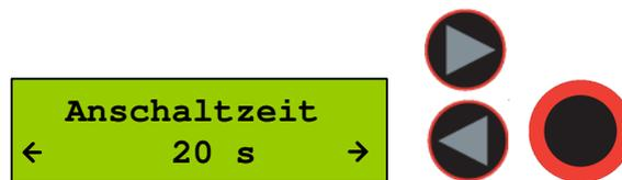
Die Zeitdauer kann in 5 Sekunden Schritten mit den Pfeiltasten eingestellt werden. Durch drücken der Haupttaste wird die Einstellung übernommen und ist ab sofort aktiv.
