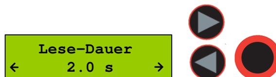
Mit den Pfeiltasten wird die gewünschte Zeitdauer in 0,5 Sekunden Schritten eingestellt, durch drücken der Haupttaste wird die Einstellung übernommen und ist ab sofort aktiv.
