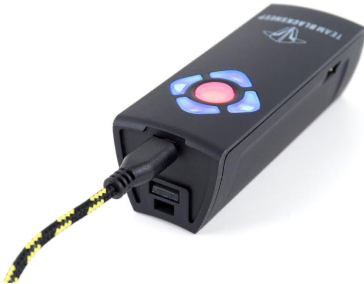
Während des Ladevorganges pulsiert die mittlere LED rot, bis der Tracker vollständig aufgeladen ist. Danach wechselt die Farbe zu grün.
