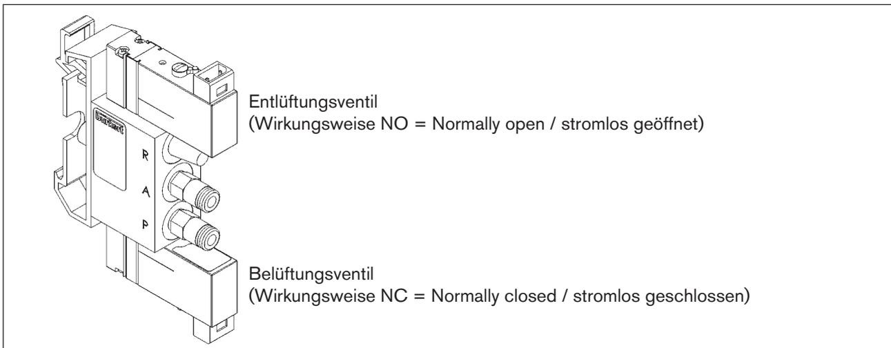
Bild 35: Ansteuerblock 8810 für Ansteuerung Prozessventil
