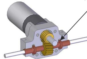
Getriebedeckel lose aufschrauben, nach dem Einlaufen über Kreuz festziehen:
