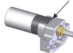
Kupferbuchsen aufschieben (müssen sich leicht auf der Achse drehen lassen), dann Achse einlegen:
