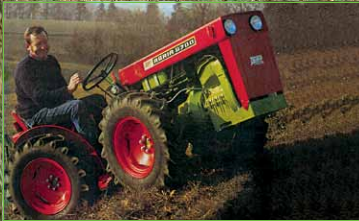
Der Agria 6700 von 1973 verfügte dank seiner Knicklenkung über einen sehr engen Wendekreis. (Foto: © Sammlung Gebhardt)
