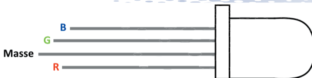
Anschlusspins einer RGB-LED
