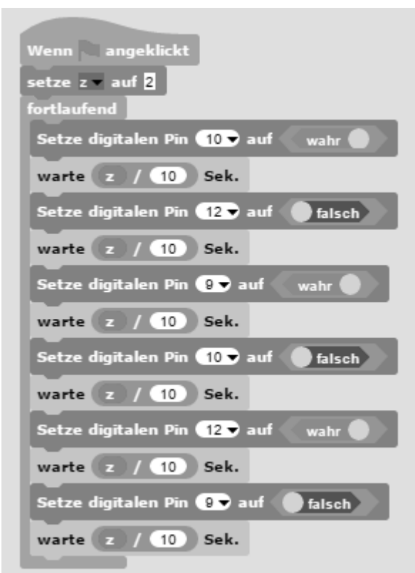
Verschiedene Farben auf einer RGB-LED.
