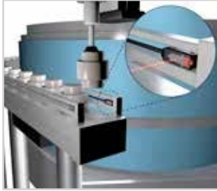
Objekterkennung bei Teileförderer
