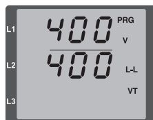
Abb. Programmier-Modus Spannungswandler Über die Tasten 1 und 2 können Primär- und Sekundärstrom geändert werden (vgl. Seite 53).
